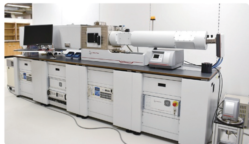
図3 小角広角 X 線散乱装置
