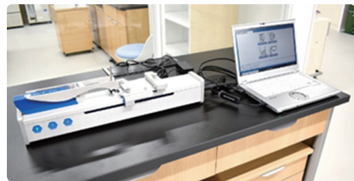
図9 毛髪多目的力学試験機
